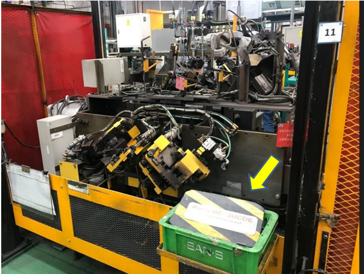
Figura 5.7 acomodo de componentes después de mejora línea 8 ensamble SUS.
